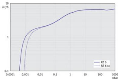
RZ 6 - График: "Вакуумирование 10 л емкости" при 60 Гц
