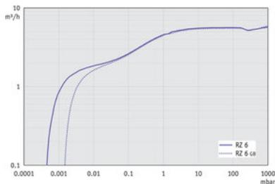
RZ 6 - График: "Вакуумирование 10 л емкости" при 50 Гц
