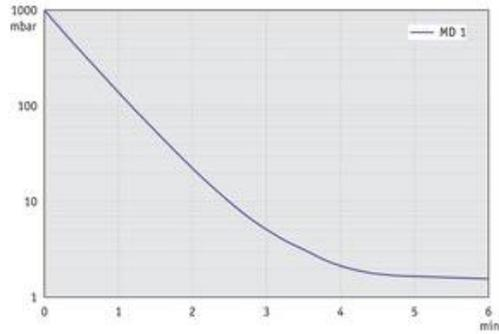
MD 1 - График: "Скорость откачивания при 60 Гц"
