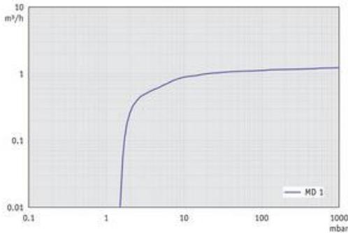
MD 1 - График: "Вакуумирование 10 л емкости" при 50 Гц
