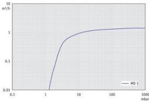
MD 1 - График: "Вакуумирование 10 л емкости" при 60 Гц
