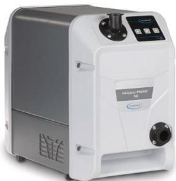
Сухой Винтовой насос VACUU·PURE® 10 надежно обеспечивает преимущества безмасляной вакуумной технологии в диапазоне вакуума до  $10^{-3}$  мбар. Насос VACUU·PURE 10 сочетает в себе три важных преимущества для пользователя: 100% отсутствие масла, отсутствие абразивного истирания и изнашиваемых деталей.
