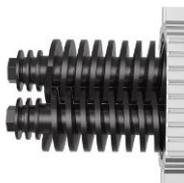
С насосами VACUU·PURE принцип сухого и безмасляного функционирования винтового насоса выходит на новый уровень. Специальная конструкция с двумя консольными винтами и магнитной передачей обеспечивает полностью безмасляное функционирование. Насос обеспечивает чистоту процессов и продуктов, а также защищает лабораторию и окружающую среду. Экономит время и эксплуатационные расходы, поскольку нет необходимости утилизировать отработанное масло или прерывать работу для замены масла.
